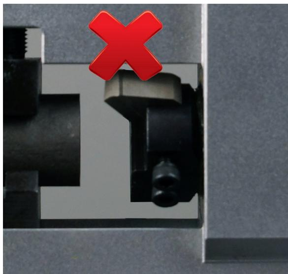
**После установки резца не подключая торцеватель к сети повернуть резцедержатель вручную вокруг оси чтобы убедиться что установленный резец не задевает части машины.**
