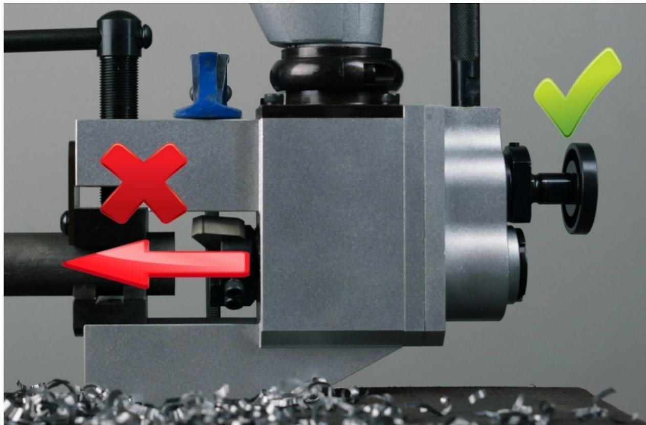
**Обязательно контролировать автоматическую подачу подачу чтобы не допустить достижения резцами частей торцевателя.**
